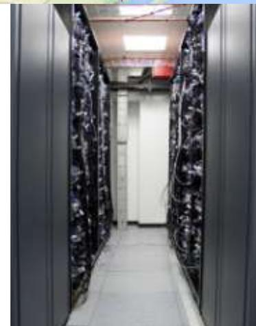
1 стойка = 256 узлов: Intel Xeon (14c) + NVIDIA K40= 515 Tflor/s
