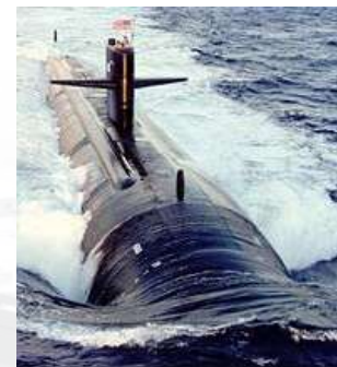
Ламинарное (на переднем плане) и турбулентное течение вокруг подлодки
